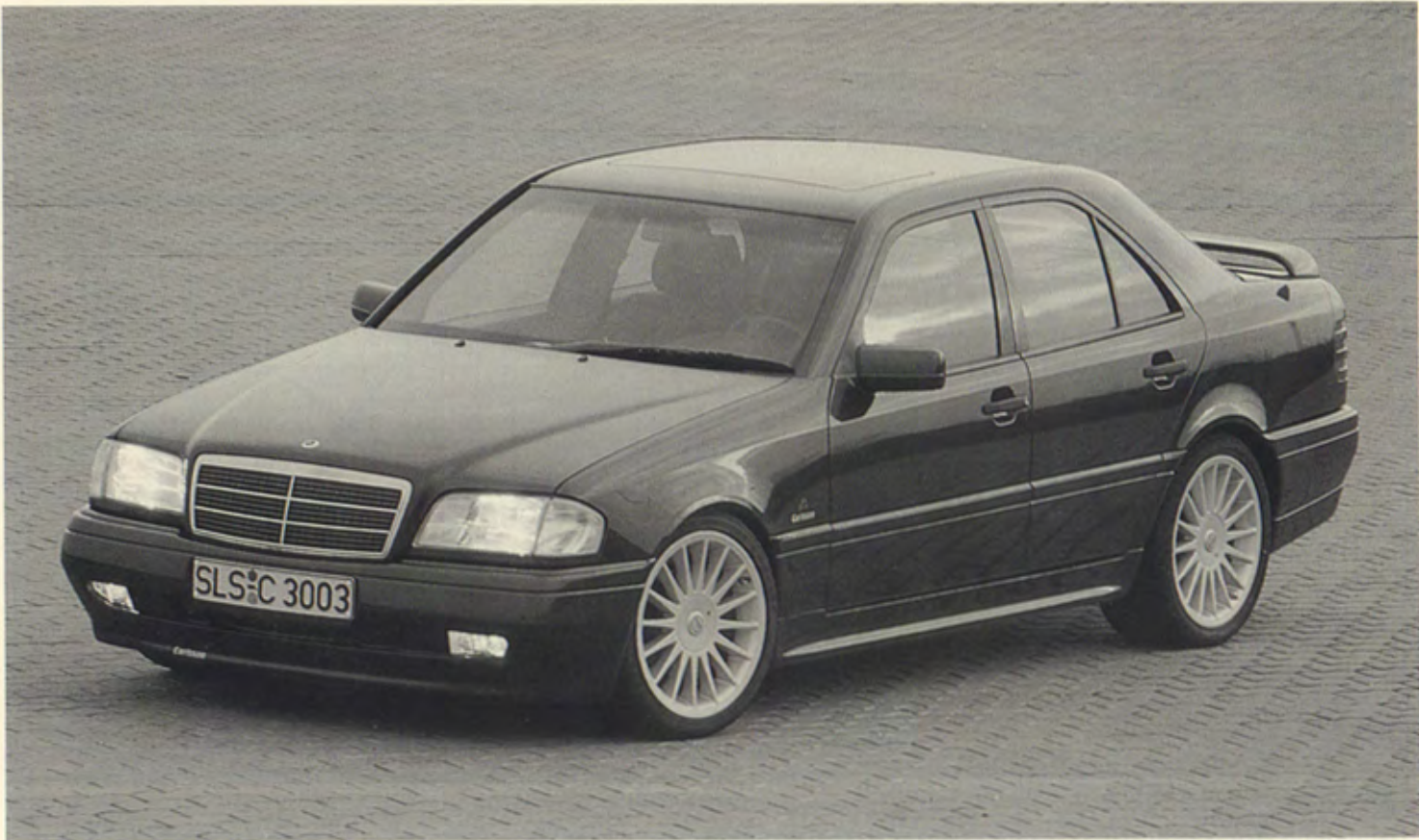
Carlsson C36 (Basis/Basis/Base C280), Aerodynamik/aerodynamic/aérodynamique, Weitstrahler im Frontspoiler/driving lights in front spoiler/phares longue portée pour spoiler avant, Heckschürze für Carlsson-Auspuff-Endrohr/rear skirt for Carlsson exhaust tailpipe/jupe arrière pour sortie Carlsson, Heckflügel mit Mittelbremsleuchte/rear wing with centre brake light/aileron arrière avec feu de stop intermédiaire, Sportfahrwerk/sport suspension/suspension sport
