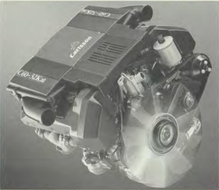
Carlsson Motor/Carlsson engine/moteur Carlsson C60 V8 6.0l 290kW(395PS) für/for/pour E420
