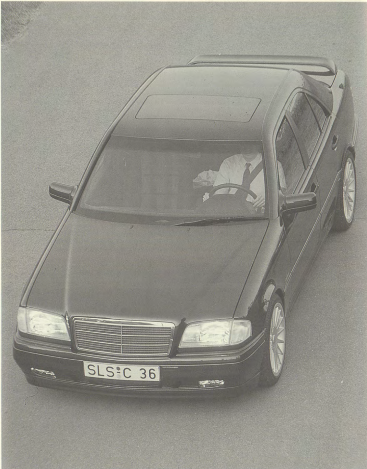
C36 3.6l (Basis/basis/base C280), Frontspoiler mit integrierten Weitstrahlern/front spoiler with driving lamps/spoiler avant avec phares longue portée, Heckflügel/rear wing/aileron arrière, Radsatz/set of wheels/jeu de jantes 8,5x18" Design 1/15 mit/with/avec 225/40 und/and/et 255/35 ZR18 Pirelli PZero
