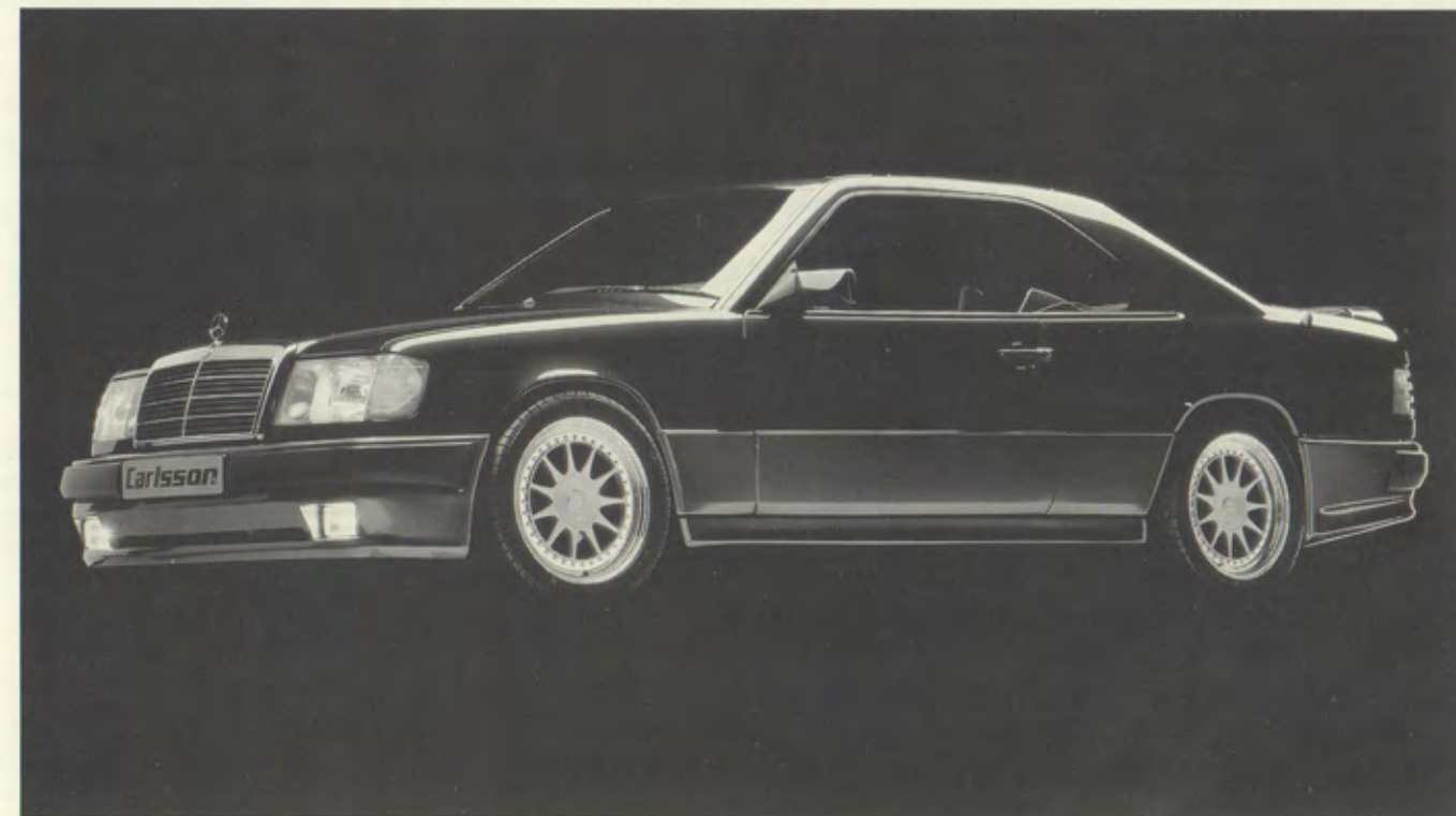
Oben/top/en haut 300CE-24 mit Aerodynamik rundum und Weitstrahlern im Frontspoiler/with aerodynamic parts all around and driving lights in front spoiler/avec pièces aérodynamiques et phares longue portée pour spoiler avant, Heckflügel/rear wing/aileron arrière, Sportfahrwerk/ sport suspension/suspension sport, Radsatz/set of wheels/jeu de jantes 8,0x17" Design 3/11 mit/with/avec 235/45 ZR 17
