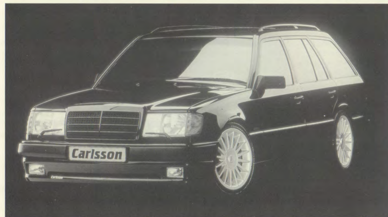
Unten/bottom/en bas E320 T-Limousine mit Motor-Umbau/with engine conversion/avec modification du moteur C36 3.6l 306kW(280PS), Umbau wie oben/conversion as above/modification comme ci-dessus, Radsatz/set of wheels/jeu de jantes 8,5x18" Design 1/15 mit/with/avec 225/40 und/and/et 255/35 ZR 18
