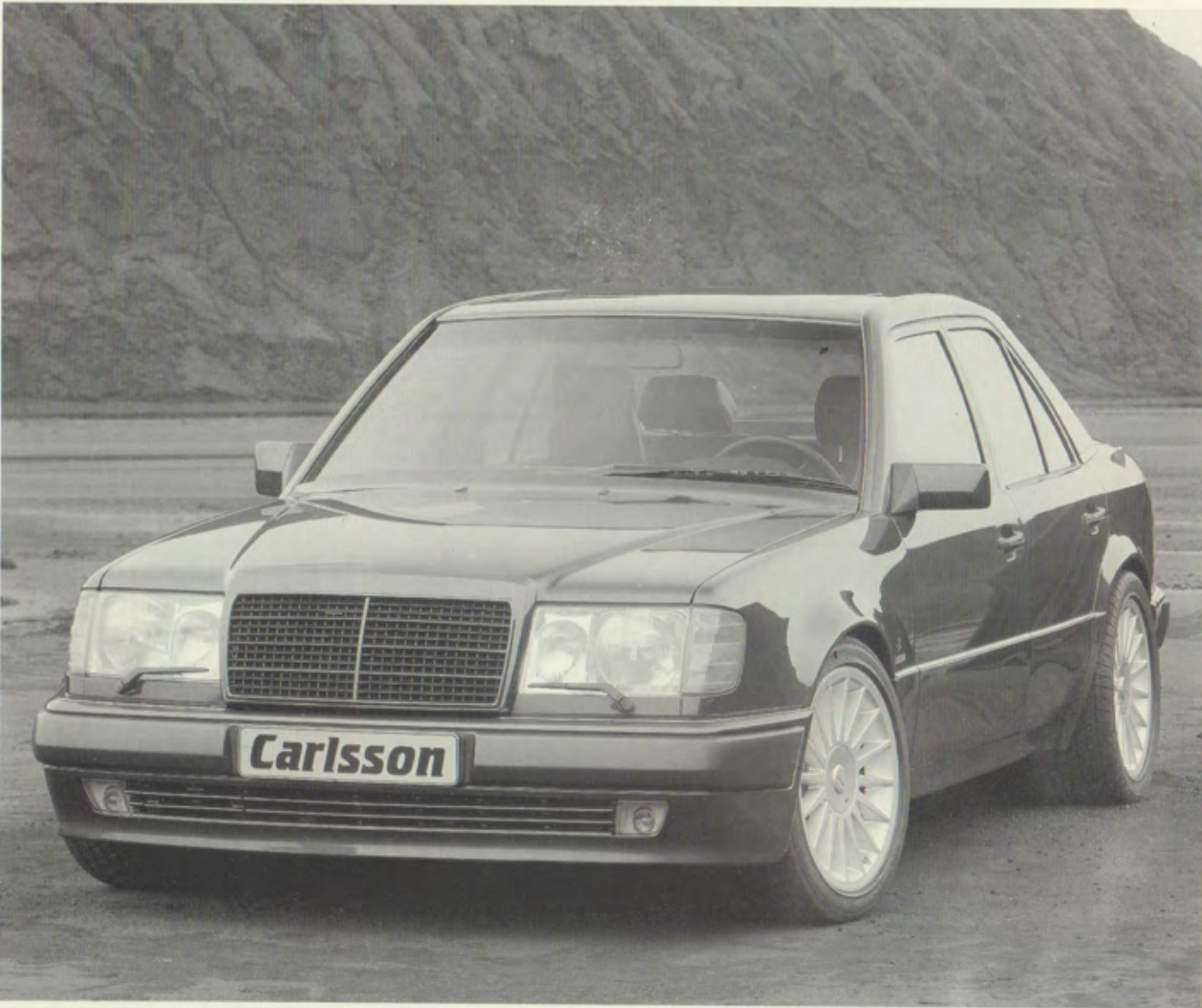
Carlsson C60 V8 6.0l 290kW(395PS) im MB 500E, Sportfahrwerk mit verstärktem Stabilisator vorne/sport suspension with strengthened front stabilizer/suspension sport avec stabilisateur renforcé avant, Sportbremsanlage/sport braking system/système de freinage sport, Radsatz/set of wheels/jeu de jantes 8,5x18" Design 1/15 mit/with/avec 235/40 und/and/et 265/35 ZR 18
