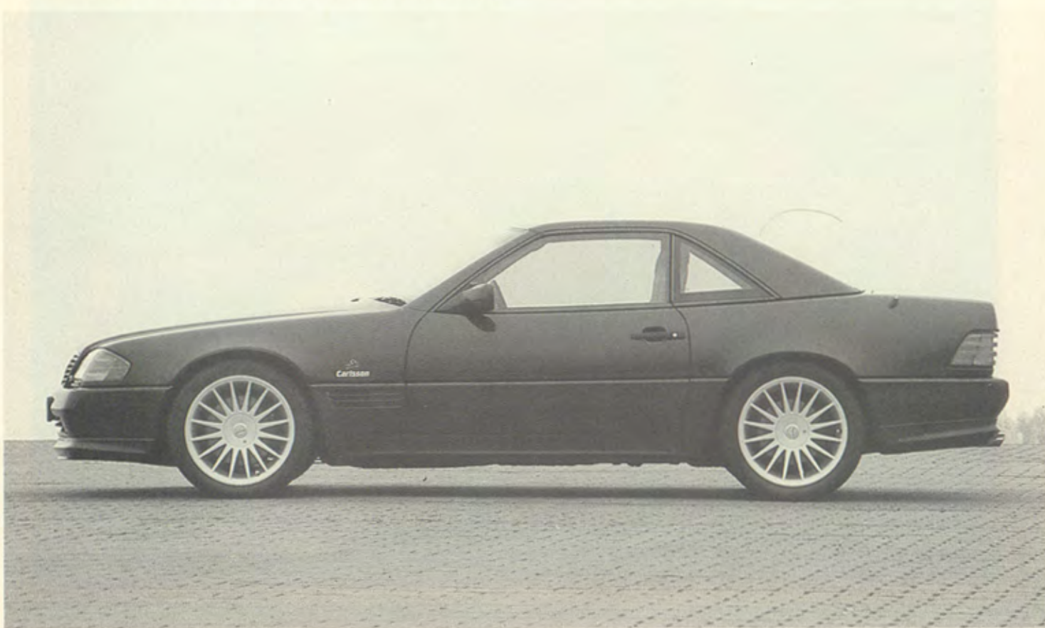
Carlsson C70 V12 6.9l 365kW(496PS), Frontspoiler/front spoiler/spoiler avant , Radsatz/set of wheels/jeu de jantes 8,5x18" Design 1/15 mit/with/avec 235/40 und 265/35 ZR18
