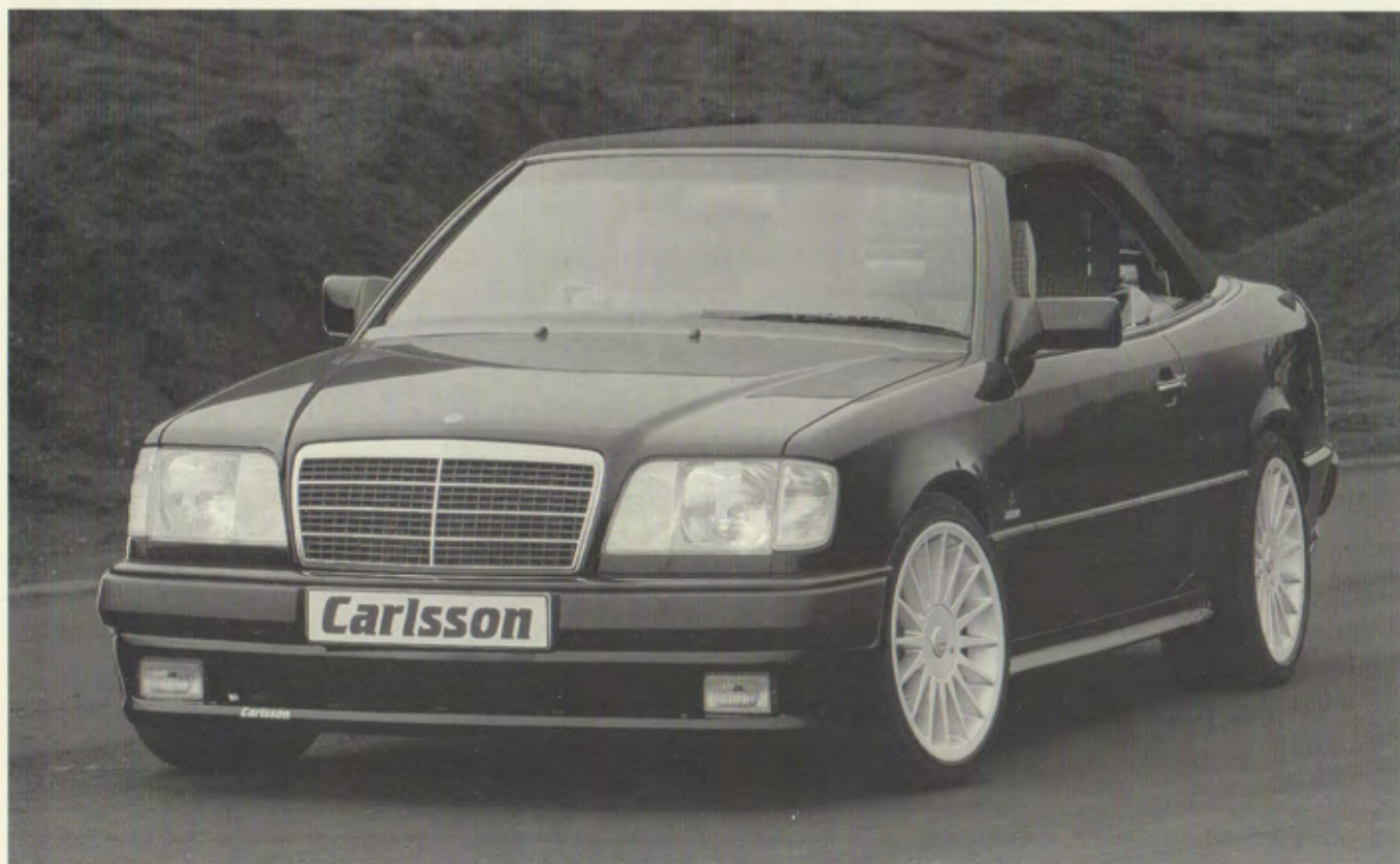
E-Klasse/E-class/Classe E, E320 Cabriolet, Aerodynamik rundum und Weitstrahler im Frontspoiler/aerodynamic parts all around with driving lights in front spoiler/pièces aérodynamiques avec phares longue portée pour spoiler avant, Sportfahrwerk/sport suspension/suspension sport, Radsatz/set of wheels/jeu de jantes 8,5x18" Design 1/15 mit/with/avec 225/40 und/and/et 255/35 ZR 18 Pirelli PZero
