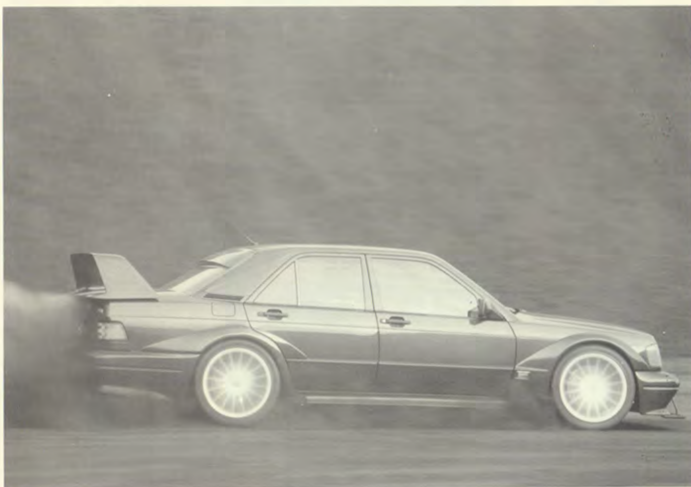
190E 2.5-16 EVO II mit Carlsson Sportmotor/with Carlsson sport engine/avec moteur sport Carlsson C25-16 RS 2.5l 235kW(320PS), Carlsson EVO-Sportfahrwerk/EVO sport suspension Carlsson/suspension sport EVO Carlsson, Sportbremsanlage/sport braking system/système de freinage sport, Radsatz/set of wheels/jeu de jantes 8,5x18" Design 1/15 mit/with/avec 235/40 und/and/et 265/35 ZR 18 Pirelli PZero
