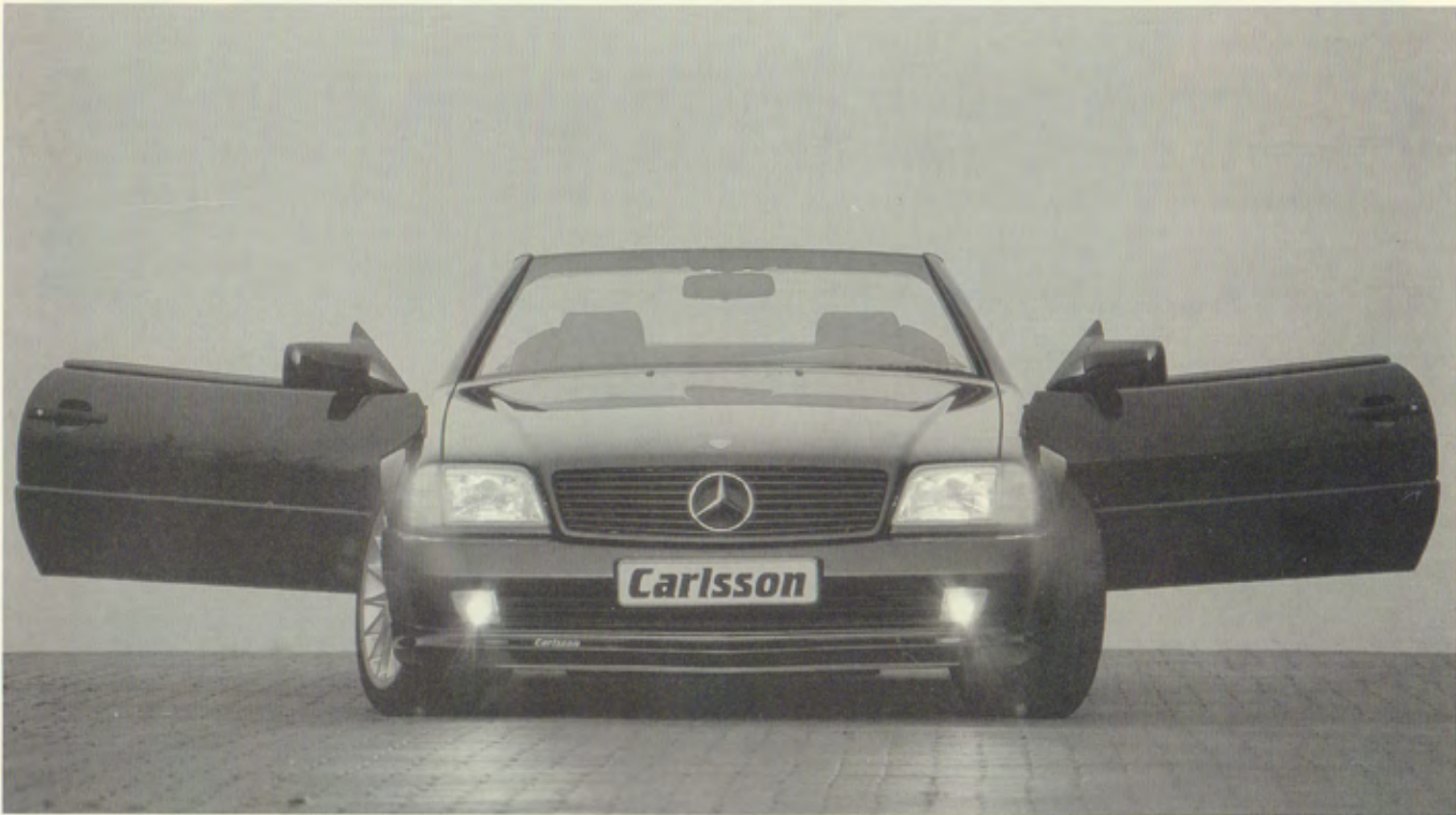
R129 mit Frontspoiler und Heckschürze (für Carlsson Auspuff)/with front spoiler and rear skirt (for Carlsson exhaust)/avec spoiler avant et jupe arrière (pour échappement Carlsson), Tieferlegung/lowering/jeu de ressorts, Radsatz/set of wheels/jeu de jantes 8,5x18" Design 1/15 mit/with/avec 235/40 und/and/et 265/35 ZR 18
