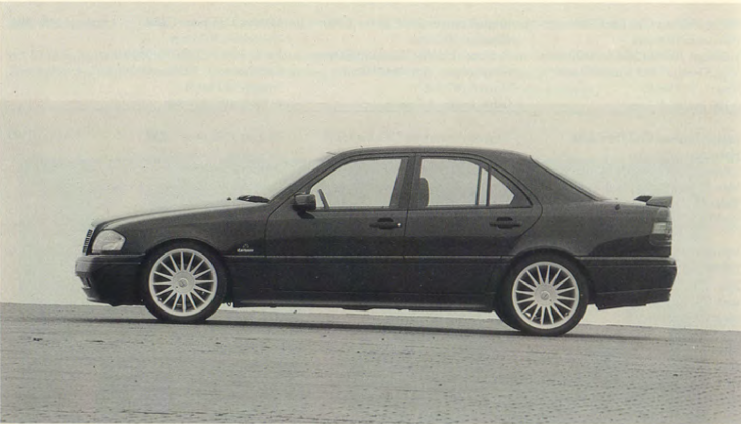
Carlsson C36 (Basis/Basis/Base C280), Aerodynamik/aerodynamic/aérodynamique, Weitstrahler in Frontspoiler/driving lights in front spoiler/phares longue portée pour spoiler avant, Heckschürze für Carlsson-Auspuff-Endrohr/rear skirt for Carlsson exhaust tailpipe/jupe arrière pour sortie Carlsson, Heckflügel mit Mittelbremsleuchte/rear wing with centre brake light/aileron arrière avec feu de stop intermédiaire, Sportfahrwerk/sport suspension/suspension sport
