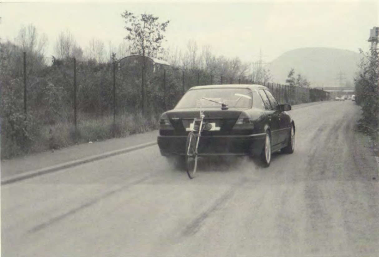
Meßfahrt mit dem Peiseler-Rad Test driving for time taking with Peiseler wheel Cours d'essai pour prendre du temps avec jante Peiseler
