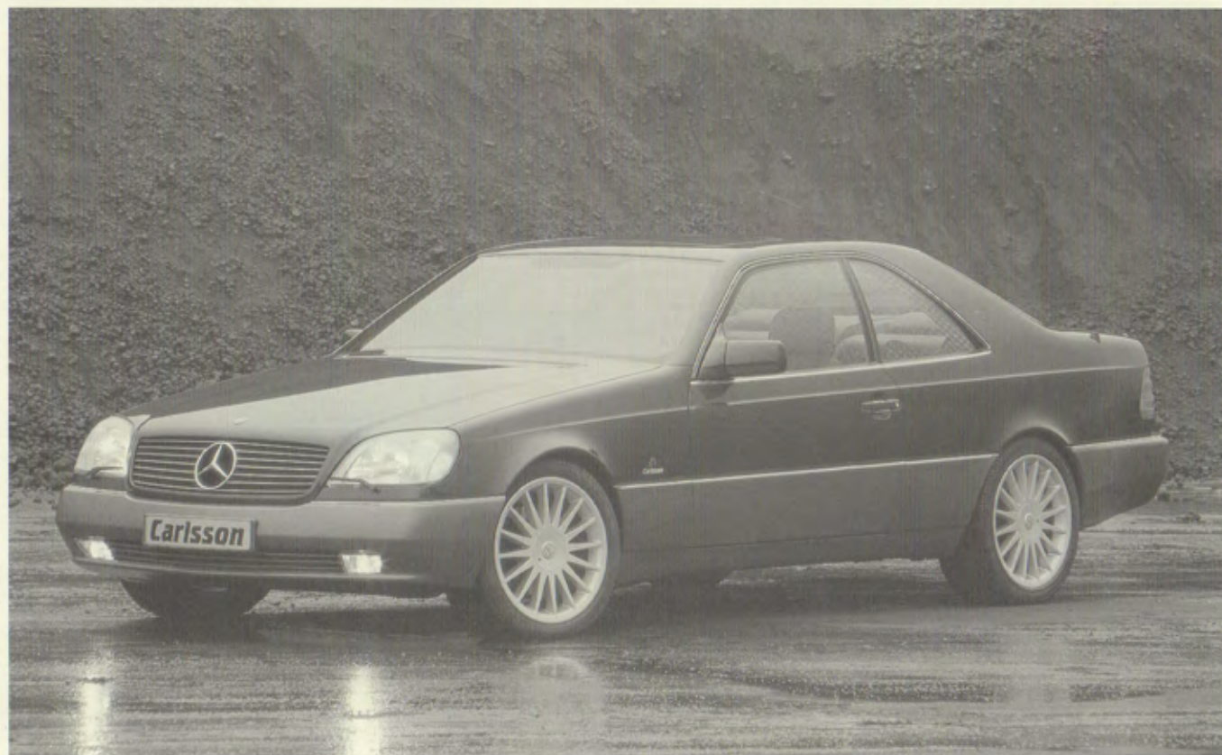
Oben/top/en haut S 600 Coupé mit Tieferlegung/with lowering/avec jeu de ressorts, Radsatz/set of wheels/jeu de jantes 8,5x18" Design 1/15 mit/with/avec 255/45 ZR 18
