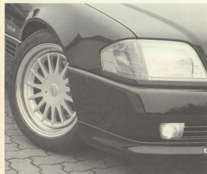
Carlsson C70 V12 6.9l 365kW(496PS), Heckschürze mit Carlsson Sport-Nachschalldämpfer/rear skirt with Carlsson sport rear silencer/jupe arrière avec silencieux arrière sport Carlsson, Tieferlegung/lowering/jeu de ressorts, Radsatz/set of wheels/jeu de jantes 8,5/10x17" Design 3/15 mit/with/avec 235/45 und/and/et 265/40 ZR 17
