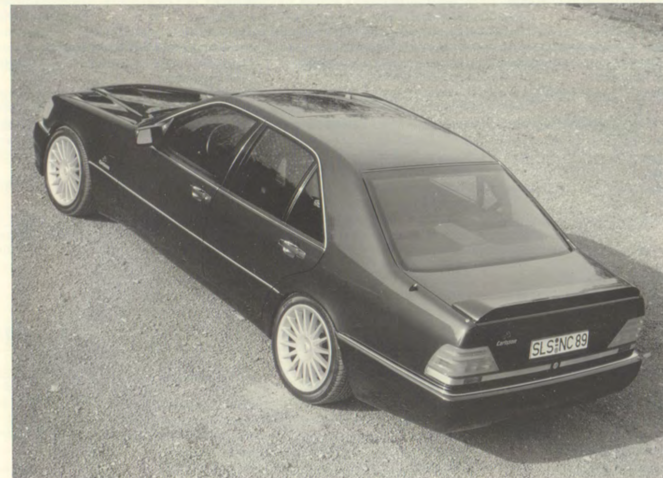
W140, Sportfahrwerk/sport suspension/suspension sport, Radsatz/set of wheels/jeu de jantes 8,5x18" Design 1/15 mit/with/avec 255/45 ZR18 (Heckflügel nicht lieferbar/rear wing not available/aileron arrière pas livrable)
