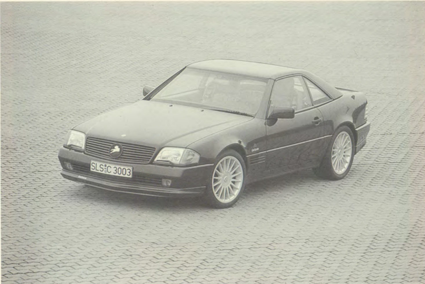
Carlsson C70 V12 6.9l 365kW(496PS), Frontspoiler/front spoiler/spoiler avant , Radsatz/set of wheels/jeu de jantes 8,5x18" Design 1/15 mit/with/avec 235/40 und 265/35 ZR18
