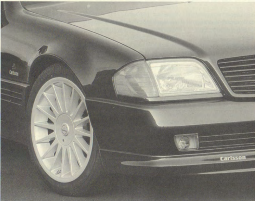
Oben/top/en haut Alurad/aluminium wheel/jantes en alu 8,5x18" Design 1/15 mit/with/avec 235/40 ZR 18 Pirelli PZero, Fahrzeug-Tieferlegung/lowering/jeu de ressorts
