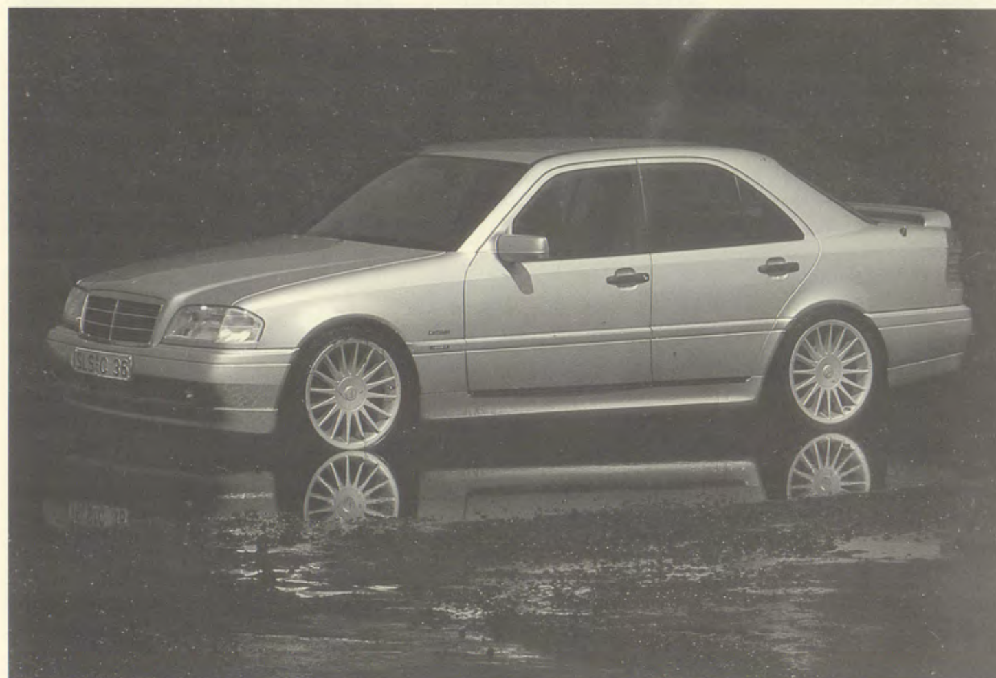
C36 3.6l (Basis/basis/base MB C280), Frontspoiler mit integrierten Weitstrahlern/front spoiler with driving lamps/spoiler avant avec phares longue portée, Heckflügel/rear wing/aileron arrière, Radsatz/set of wheels/jeu de jantes 8,5x18" Design 1/15 mit/with/avec 225/40 und/and/et 255/35 ZR18 Pirelli PZero
