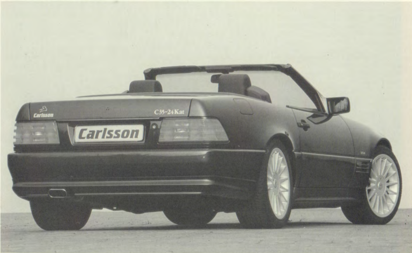
R129 mit Frontspoiler und Heckschürze (für Carlsson Auspuff)/with front spoiler and rear skirt (for Carlsson exhaust)/avec spoiler avant et jupe arrière (pour échappement Carlsson), Tieferlegung/lowering/jeu de ressorts, Radsatz/set of wheels/jeu de jantes 8,5x18" Design 1/15 mit/with/avec 235/40 und/and/et 265/35 ZR 18
