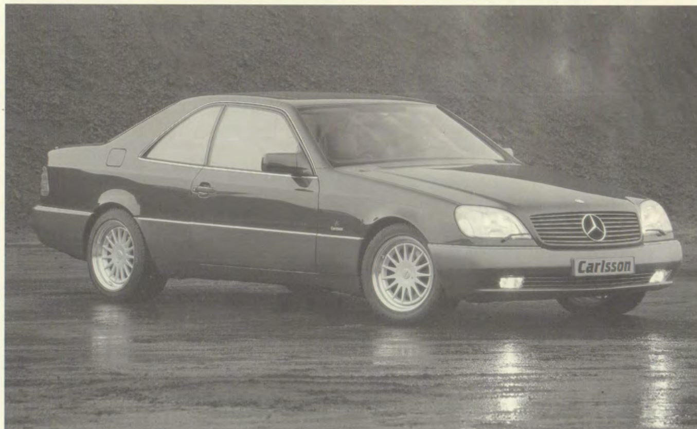
Unten/bottom/en bas wie oben/as above/comme ci-dessus, Radsatz/set of wheels/jeu de jantes 8,5/10x17" Design 3/15 mit/with/avec 255/45 ZR 17
