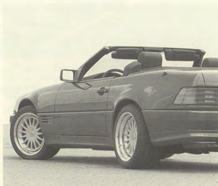
Carlsson C70 V12 6.9l 365kW(496PS), Heckschürze mit Carlsson Sport-Nachschalldämpfer/rear skirt with Carlsson sport rear silencer/jupe arrière avec silencieux arrière sport Carlsson, Tieferlegung/lowering/jeu de ressorts, Radsatz/set of wheels/jeu de jantes 8,5/10x17" Design 3/15 mit/with/avec 235/45 und/and/et 265/40 ZR 17
