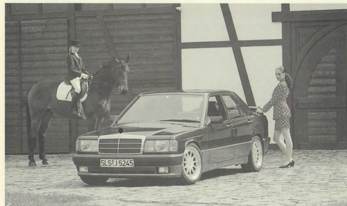
Carlsson C35 3.5l 177kW(242PS), Basis/basis/base 190E 2.6, Aerodynamik mit Weitstrahlern im Frontspoiler/aerodynamic with driving lamps in front spoiler/aérodynamique avec phares longue portée pour spoiler avant, Heckflügel/rear wing/aileron arrière, Sportfahrwerk/sport suspension/suspension sport, Radsatz/set of wheels/jeu de jantes 7,5/8,5x17" Design 3/11 mit/with/avec 245/35 ZR 17
