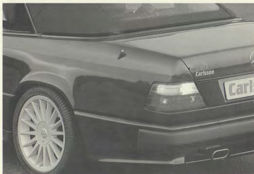
E320 Cabriolet, ovales Auspuff-Endrohr in poliertem Edelstahl für Carlsson-Heckschürze/oval exhaust tailpipe in polished stainless steel for Carlsson rear skirt/sortie d'échappement ovale en acier inoxydable pour jupe arrière Carlsson, Radsatz/set of
