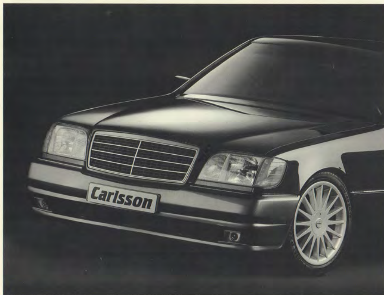
Carlsson C70 V12 6.9i 365kW(496PS), Tieferlegung/lowering/jeu de ressorts, Radsatz/set of wheels/jeu de jantes 8,5x18" Design 1/15 mit/with/avec 255/45 ZR 18
