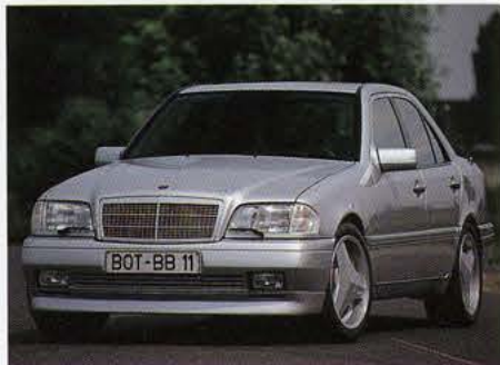
Frontstoßfänger aus Pur-Rim für die C-Klasse. Front bumpers made of Pur-Rim for the C-Class.
