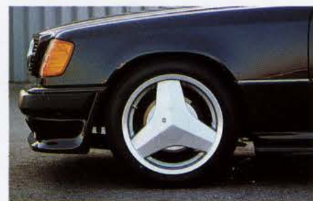
BRABUS-Monoblock II 8 x 17 ET30 in silber polierter Ausführung. BRABUS-Monoblock II 8 x 17 offset 30 in silver polished design.
