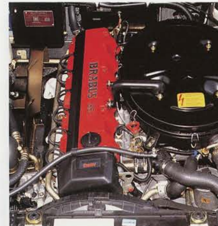
Der BRABUS 3,6 Ltr. auf Basis 300GE mit 6 Zylinder. The BRABUS 3.6 litre based on 300GE with 6 cylinder.
