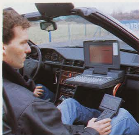
Erfassung der Quer- und Längsbeschleunigung mittels PC. Recording of cross and longitudinal acceleration by PC.
