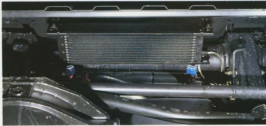
Der Ölkühler für den BRABUS 3.6 6-Zylinder auf Basis 300GE. The oil cooling system for the BRABUS 3.6 6-cylinder engine based on 300GE.
