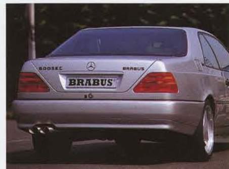
BRABUS-Heckschürze und Sportauspuff- anlage. BRABUS rear bumper with sports exhaust system.
