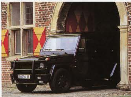
BRABUS Rammschutzbügel schwarz matt beschichtet. BRABUS ram protection coated mat black.
