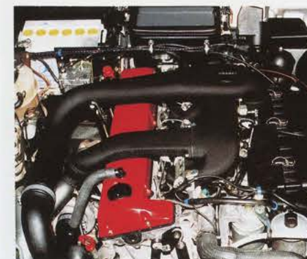
Der BRABUS Intercooler auf Basis 350GDT. The BRABUS intercooler based on 350GDT.
