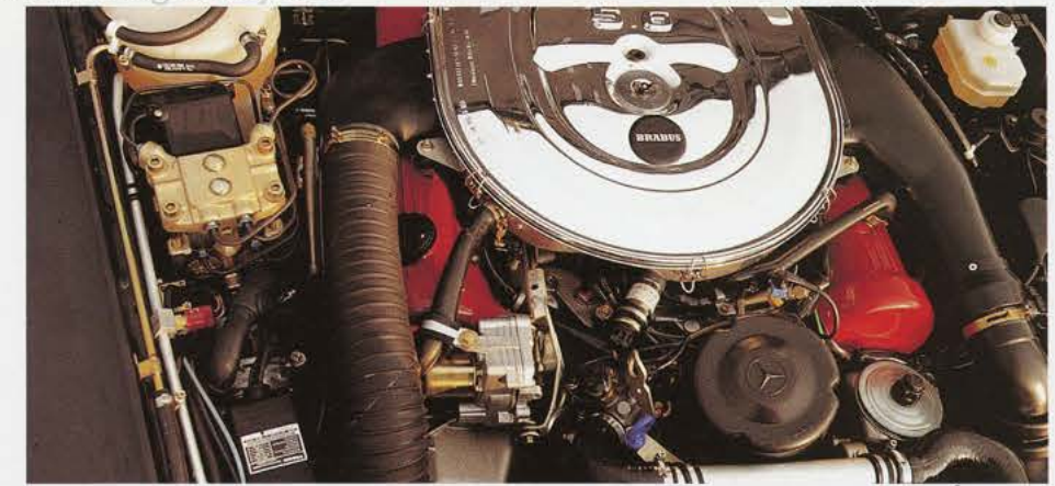
BRABUS Hubraumhöhung 5,6 Liter auf Basis 8-Zylinder 500 GE. BRABUS enlarged displacement 5.6 litre based on the 8-cylinder 500 GE.
