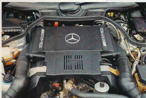
Gut frisiert: Die Kur bei AMG bescherte dem Mercedes-V8 einen Liter mehr Hubraum und 48 zusätzliche PS
