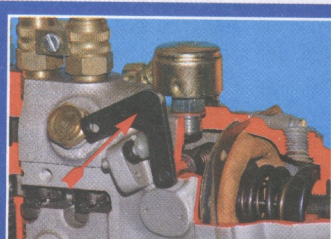
Der Kaltstarthebel (Pfeil) sorgt für eine Anreicherung des Gemischs
