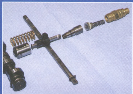
Nockenwelle, drehbarer Kolben, Regelstange, Zylinder, Druckventil und Leitungsanschluss (v.l.)
