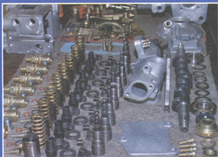
Die Zahl der Teile einer Mercedes-600-Pumpe zeigt, wie komplex sie aufgebaut ist
