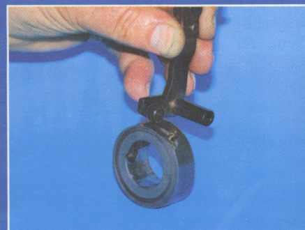
Die eingefräste Nockenbahn ermöglicht eine zweidimensionale Regelung
