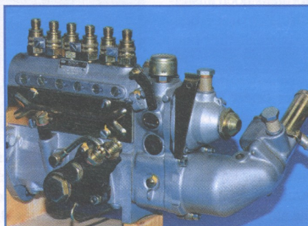
Die „Adenauer“-Pumpe stammt vom 300 SL ab, hat aber zusätzlich eine Warmlaufeinheit
