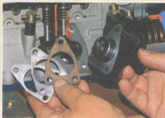
Der Hub der Benzinpumpe wird durch Distanzscheiben festgelegt
