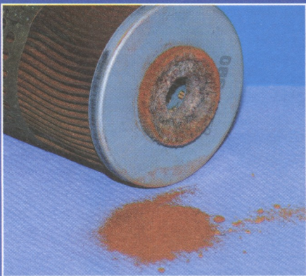
Ein intakter Benzinfilter ist für mechanische Einspritzanlagen besonders wichtig
