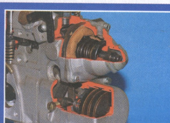
Oben die Unterdruckmembran, unten die Höhendose: doppel regelt besser
