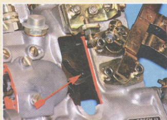
Eine Kurvenscheibe übernimmt hier die Steuerung der Regelstange
